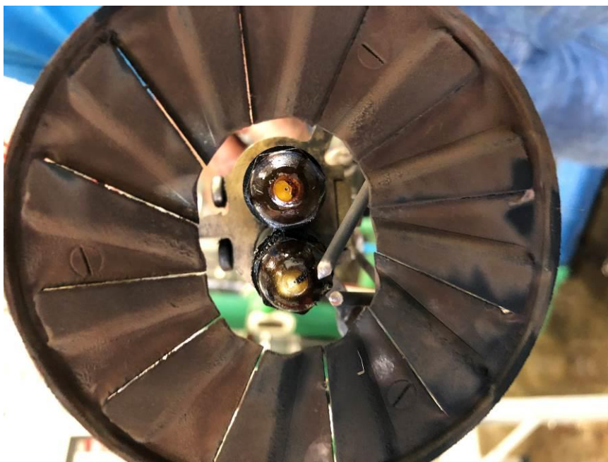
ภาพ ทำความสะอาดหัวเผาและตรวจสอบด้านสัมผัสไฟ
